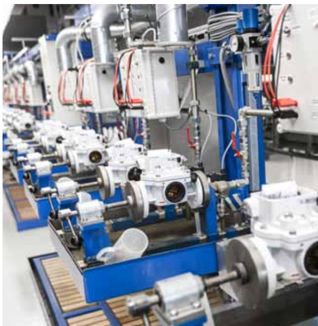
Figura 8 - Prueba funcional y de hermeticidad
